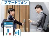
専用アプリ「スマートコントロールキー」※をダウ ンロードしたスマートフォンで施解錠ができます。 ・スマートコントロールキー専用アプリ「スマートコントロールキー」は、ドアとBluetoothを介してベアリングすることで、施解錠、キーの管理、施解錠履歴の確認などを行える専用アプリです。
