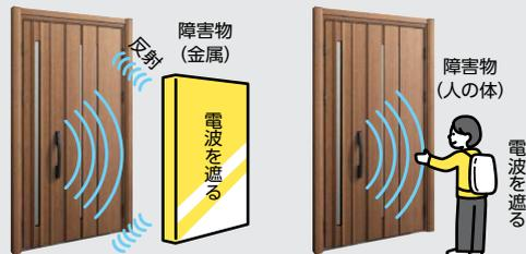
※特に金属は電波を反射しやすく、電波を遮断します。
