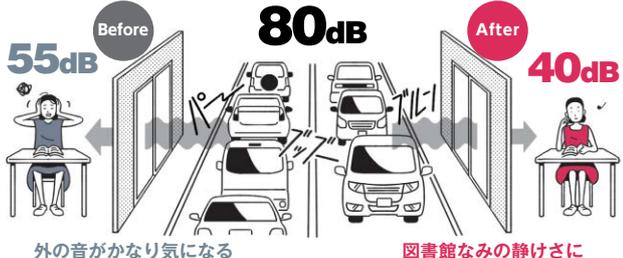
●Before:一般的なアルミサッシと単板ガラス(5mm)の組合せ ●After:外窓 フレミングII引違い窓外付け枠 単板ガラス(5mm)/中間空気層84mm/内窓 プラマードU単板ガラス(5mm)
